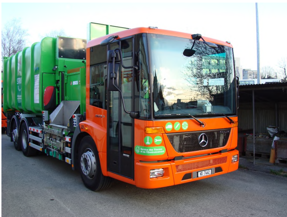
Camion équipé du système IES, actuellement en service à Yverdon-les-Bains. Les ordures sont chargées latéralement.
