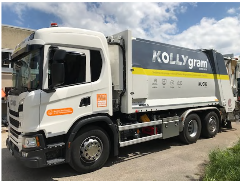
Camion BOM testé par la Municipalité en 2019. Le système est à chargement arrière.
